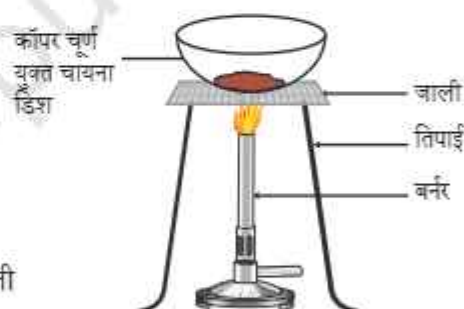
चित्र 1.10 कॉपर का कॉपर आक्साइड में उपचयन
